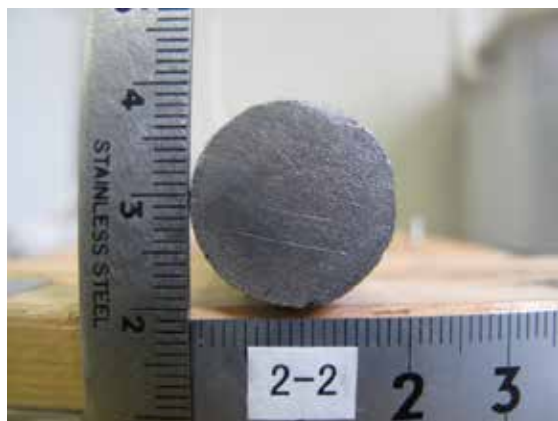
ほぼ健全な鉄筋 ( \phi 19 程度)
