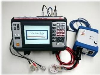
アンカーパルステスターは、超音波法によってあと施工アンカーの長さを測定する機能と、電磁パルス法によってアンカー定着部の健全性を検査する機能を併せ持ったハイブリッド機です。
