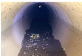
φ500mmの空間があれば飛行可能。重量が185gのため、万一の墜落の場合も施設与える損傷は考えにくい。
