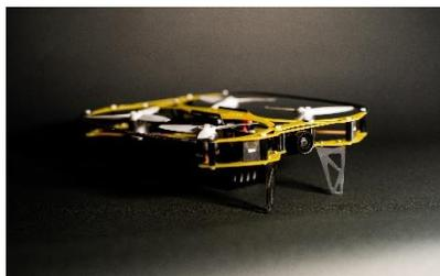
従来のドローンと異なる手のひらサイズのマイクロドローンがリスクを伴う点検業務に活躍します。橋梁の箱桁の内部やトンネルの中のコンクリートのクラック、漏水、エフロ等の変状を人間の目視に代わり観察し動画データを取得する。そこから3次元解析、オルソーデータ、点群データなど取得する。弊社は、このドローンを用い点検業務を請け負います。
