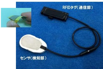
RFID腐食環境検知センサ(左)と計測機器(右)
