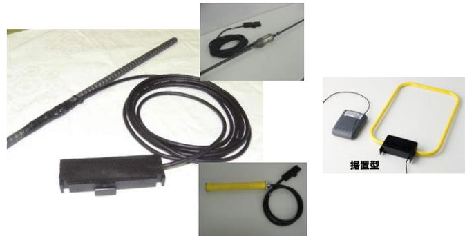
RFIDひずみセンサ各種(左)と計測機器(右)
